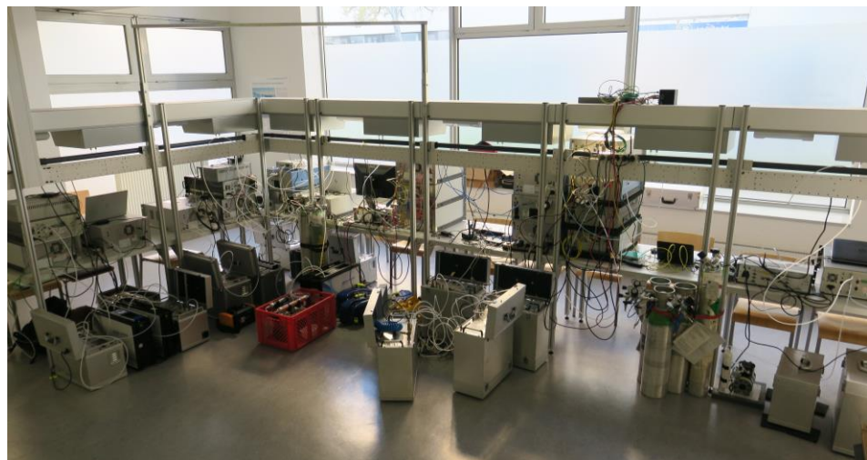
Abbildung 3: Freie Zugangsmöglichkeit zu allen Anschlüssen an den Geräterückseiten. (© Umweltbundesamt)
