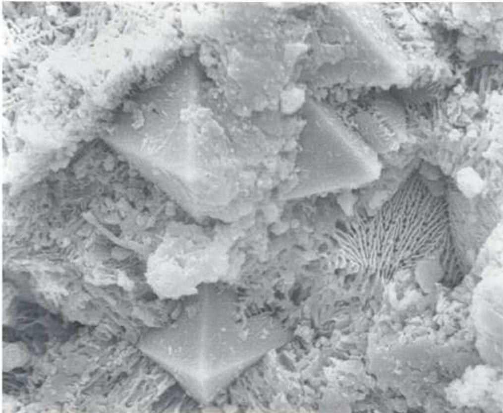
Abb. 19: REM-Aufnahme (Detail) des Mischoxidkorns in Abb. 18. Auffällig sind die oktaedrisch geformten Manganoxidkristalle. Vergrößerung: 6000fach.
