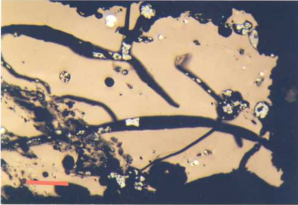
Abb. 7: polierter Anschliff einer Kohlekraftwerks-Asche (magnetische Fraktion). Unregelmäßiges, kohliges Material mit Einschlüssen von Magnetkies (weiß, z. T. globular). Ölimmersion Marke = 0.05 mm
