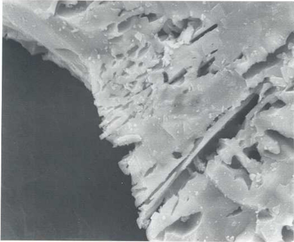
Abb. 28: Detailaufnahme von Abb. 27, Calciumferrit (leistenförmig) in RO-Mischphase. Vergrößerung: 2500fach.
