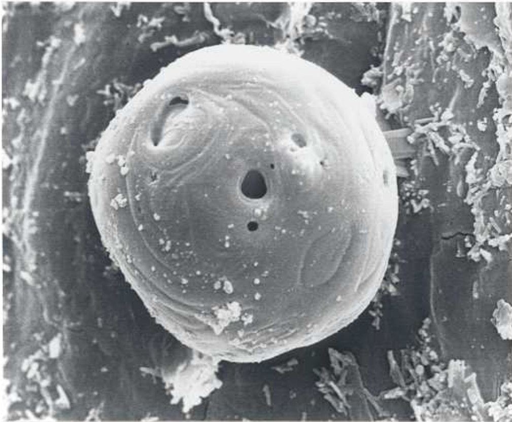
Abb. 8: REM-Aufnahme eines hohlkugeligen Partikels. Vergrößerung: 4500 fach.
