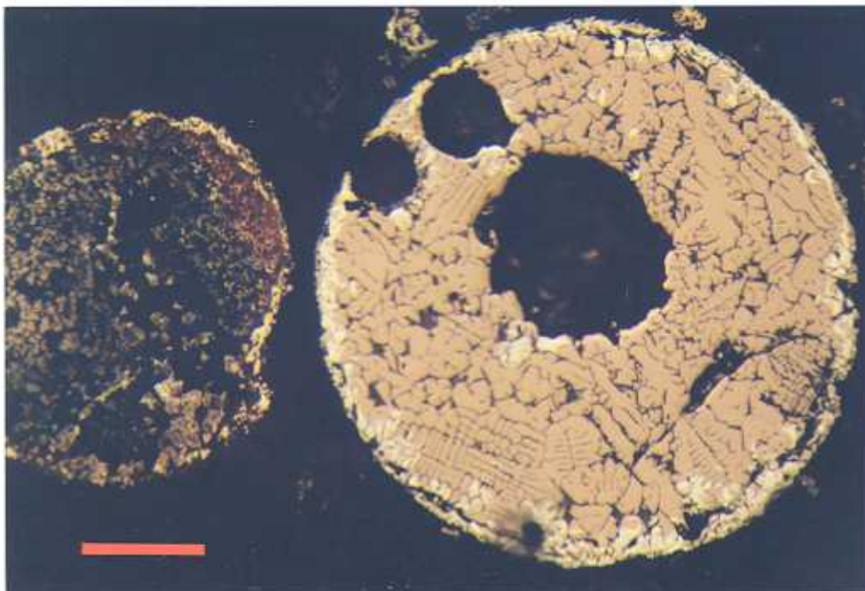
Abb. 6: polierter Anschliff einer Kohlekraftwerks-Asche (magnetische Fraktion). In der rechten Bildhalfte ein hohlkugeliges Korn mit dendritischen Magnetitkristallen, welches randlich durch Hematit (wei) verdrangt wird. Links eine Glasphase (dunkel) mit entglasten Spinell- und Magnetitkristallen. Olmersion. Marke = 0.05 mm
