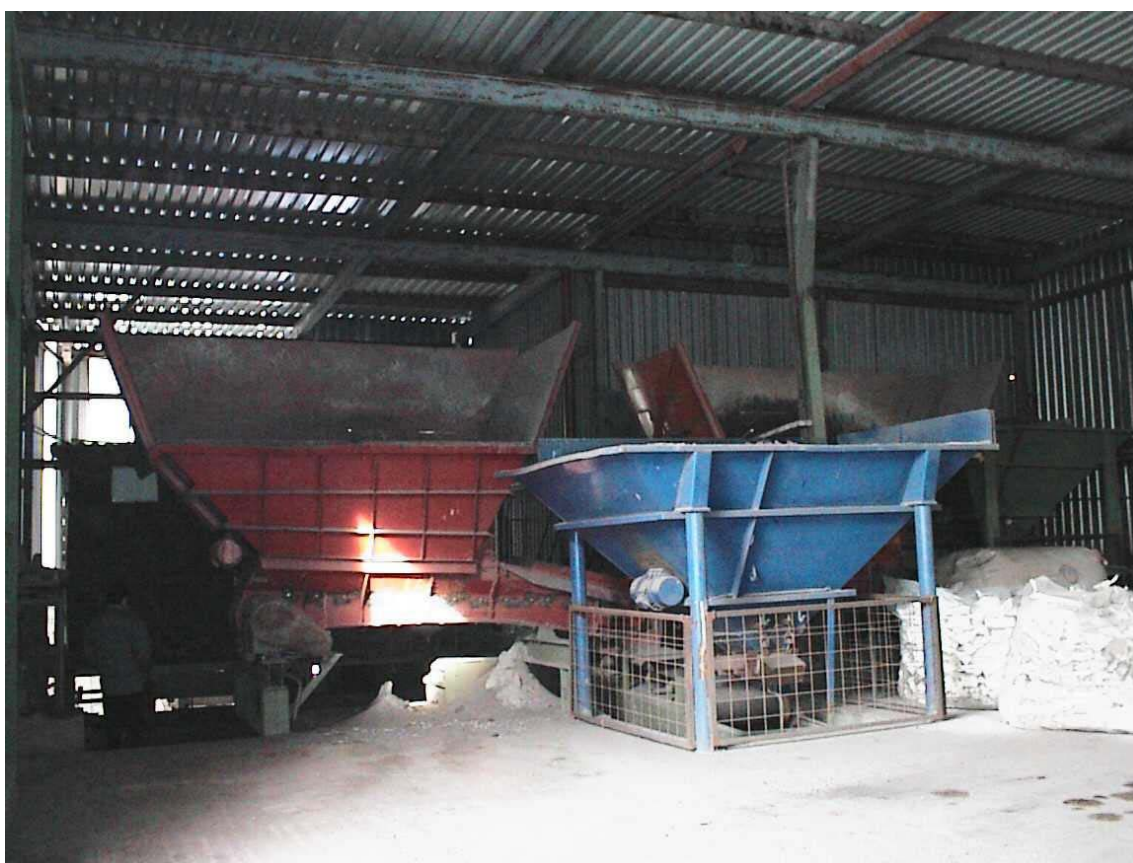
Abbildung 9: Aufgabeeinrichtungen für die Einsatzstoffe vor dem Zwangsmischer
