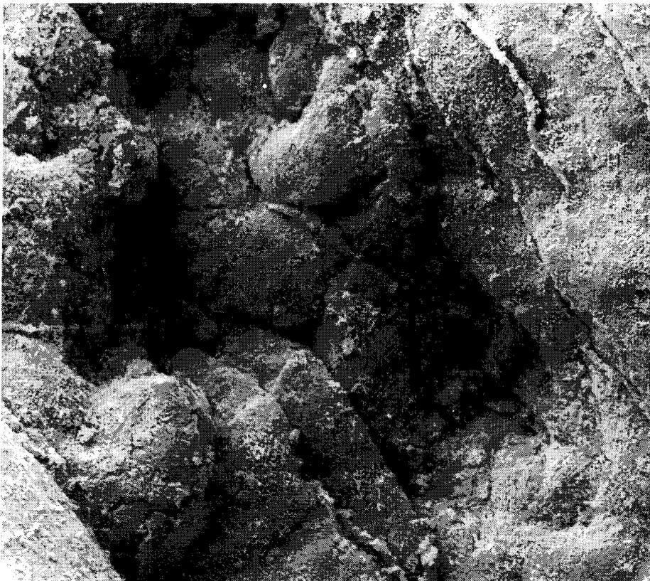
Abbildung 23: Typisches Erscheinungsbild von Verätzungsschäden (Vergrößerung: 1.050 x)
