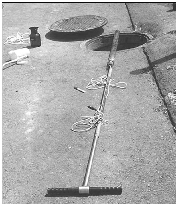
Abb. 1: Probenahme aus dem Endlager mit einem Probenehmer.
