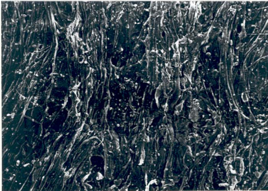
Abb. 37: Folienprobe (gereinigt) nach 43 Tagen Kompostierung.
