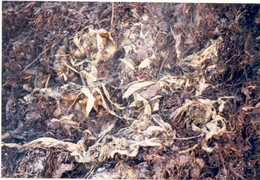
Abb. 9: Unvollständig abgebaute Foliensäcke am Ende des Kompostierungsversuches.
