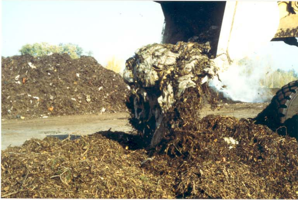
Abb. 6: Aufsetzen der Foliensäcke mittels Radlader.
