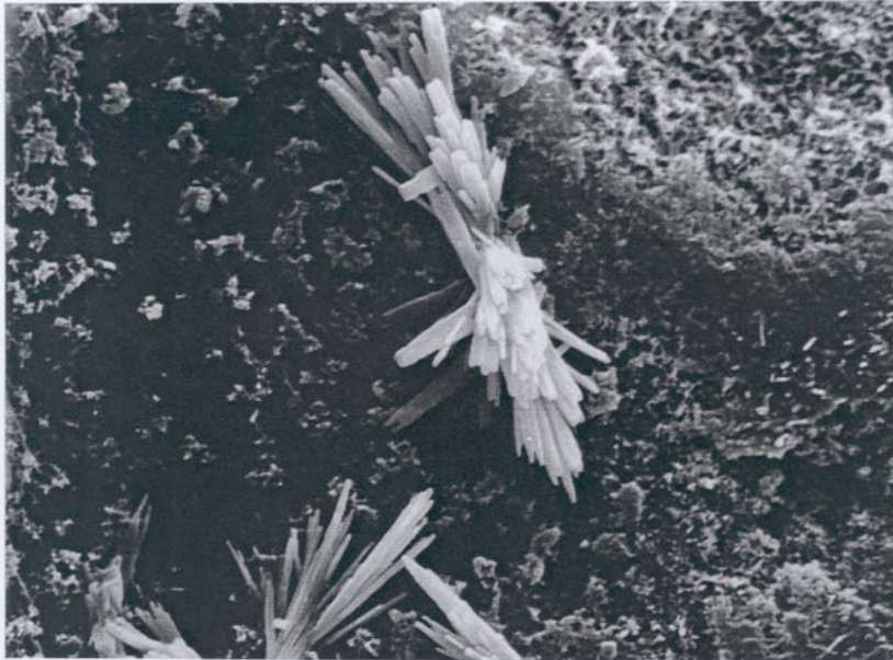
Abb. 19: Linz/Kürnberger Wald (1. Njg. 1989), REM-Aufnahme von einem Nadelbereich mit Gipskristallen, Vergrößerung: 2300 x.
