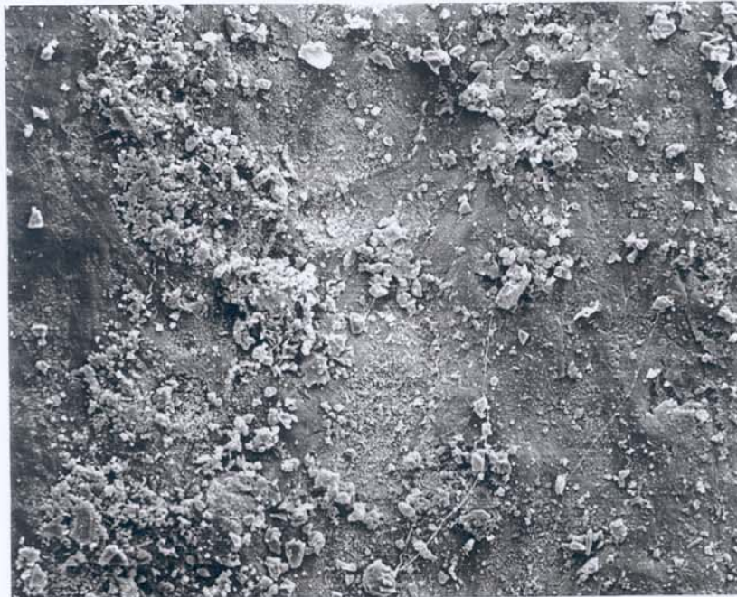
Abb. 26: Wietersdorf, W 18/1 , REM-Aufnahme eines Nadelbereiches mit massiver Staubebelegung. Vergrößerung: 350fach.
