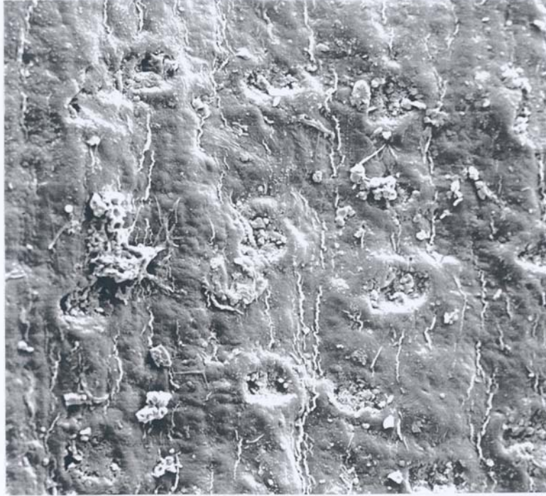
Abb. 23: Wietersdorf, W 6/2 , REM-Aufnahme einer Nadeloberfläche mit Sporen und Staubpartikeln. Vergrößerung: 350fach.
