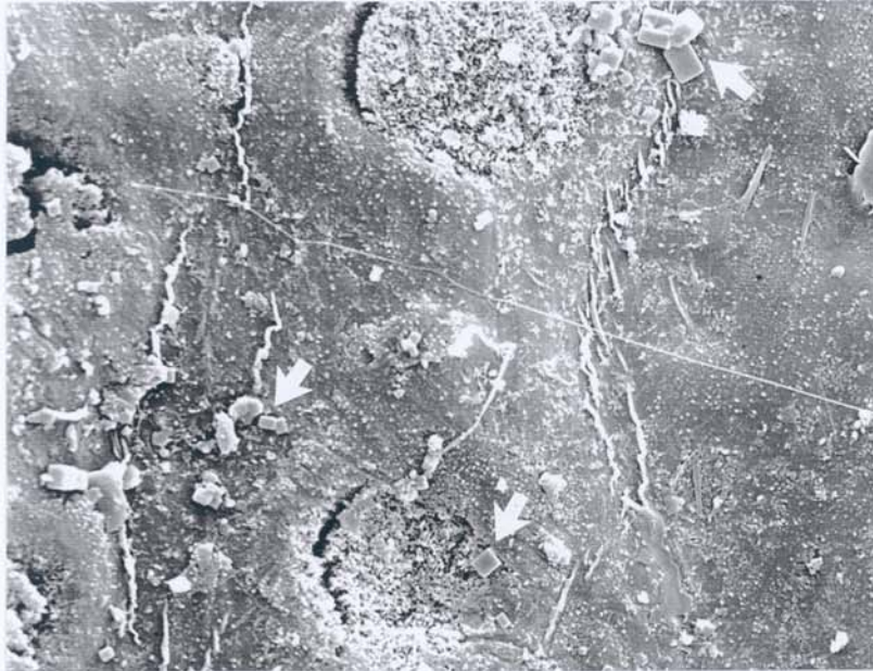
Abb. 11: Brückl , Probepunkt SW 1/2, REM-Aufnahme eines Nadelbereiches mit zahlreichen kleinen chlorhaltigen Kristallen (Pfeile). Vergrößerung: 750fach.
