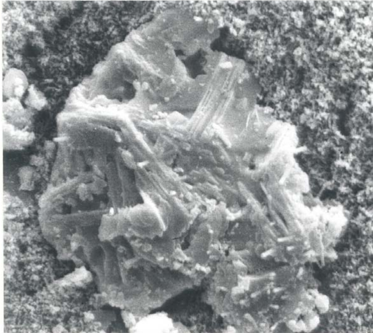
Abb. 12: LEOBEN-DONAWITZ / 103, REM-Aufnahme eines eisenhaltigen Partikels auf der Nadel. Vergrößerung: 3000fach.
