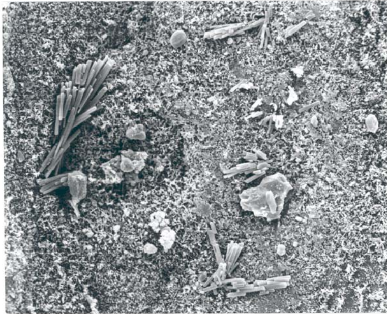
Abb. 16: LEOBEN-DONAWITZ / 76, REM-Aufnahme eines Nadelbereiches mit zahlreichen anhaftenden Gipskristallen. Vergrößerung: 1150fach.
