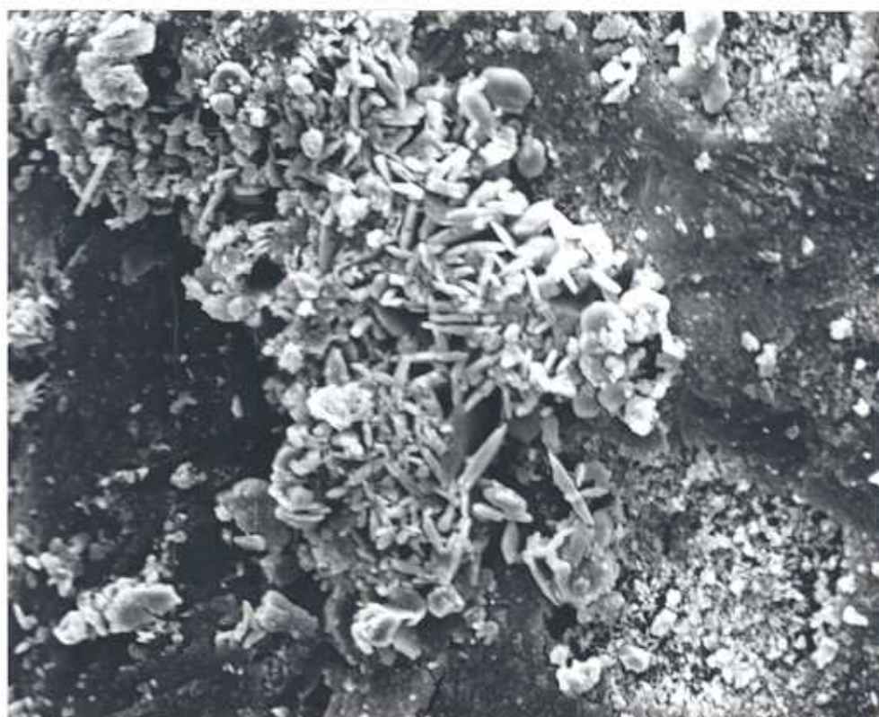
Abb. 21: PP. Wie 18/Wietersdorf, REM-Aufnahme einer Nadeloberfläche mit massiver Belegung durch Gipskristalle. Vergrößerung: 950fach.
