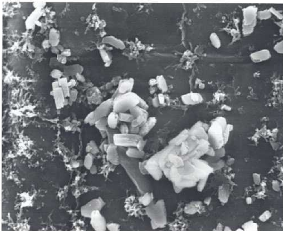
Abb. 23: PP. Wie 8/Wietersdorf, REM-Aufnahme einer Fichtennadel mit kleinen Gipskristallen. Vergrößerung: 3000fach.
