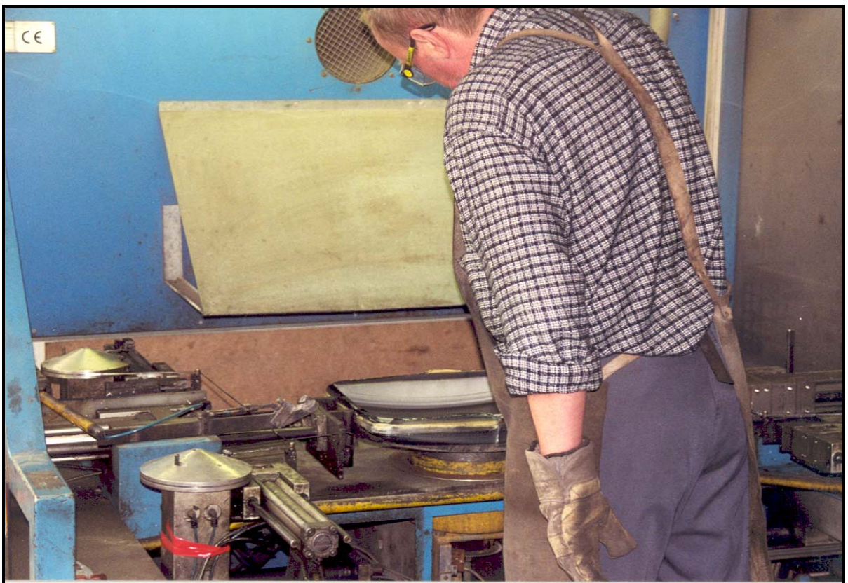
Abbildung 5: Schirmglas mit Leuchtschicht vor der trockenen Absaugung
