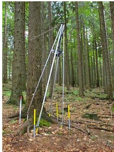
Die Konstruktion besteht aus zwei, unabhängig voneinander transportierbaren, Teilen, einer Befestigungsplatte für die Kamera und den Stativbeinen (links oben und rechts unten). Sind die Monitoringflächen stark geneigt, wie dies besonders bei den Stammablaufflächen der Fall ist (rechts oben), ist es nötig, die Stativspitze mittels eines Seiles am Trägerbaum oder einem anderen stabilen Element zu fixieren.
