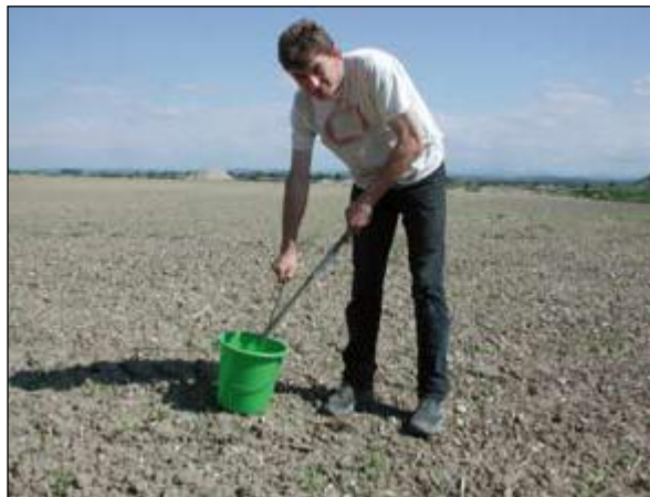
Abbildung 6: Bodenprobenahme mit Bodenbohrer. © Bundesgütegemeinschaft Kompost e.V., 2009.
