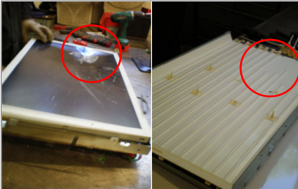
Abbildung 13: Beschädigt angeliefertes Display, äußere Beschädigung (links) und Effekt auf Hintergrundbeleuchtung (rechts) (Quelle: Umweltbundesamt).
