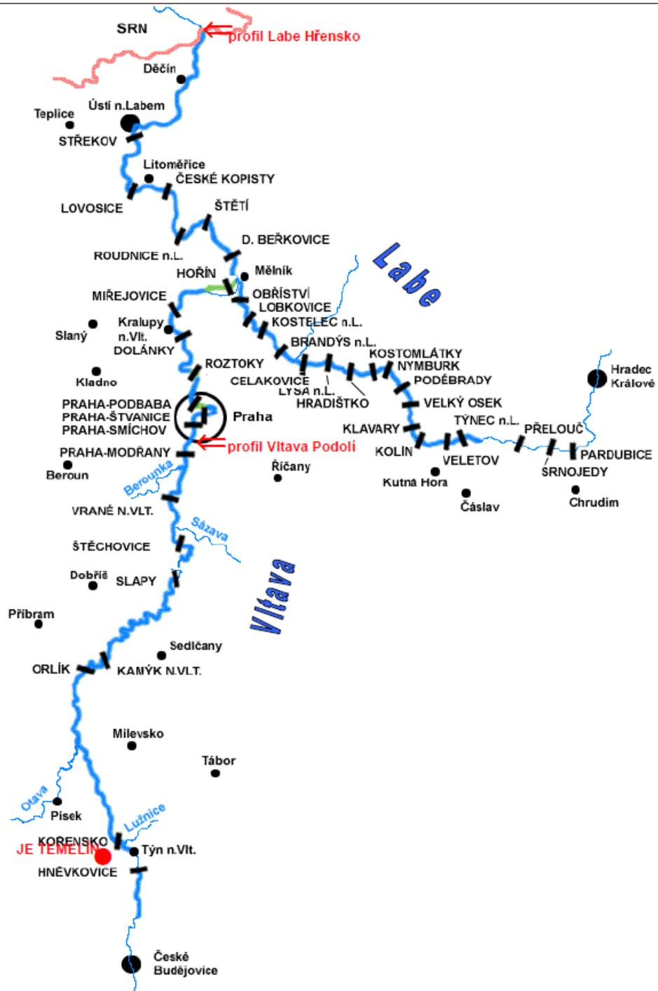
Abb. 3 Schema des wasserwirtschaftlichen Systems Moldau – Elbe mit Darstellung der Hauptprofile
