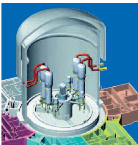
Obr. č. 22 – Ilustrativní znázornění primárního okruhu reaktoru EPR 1600
