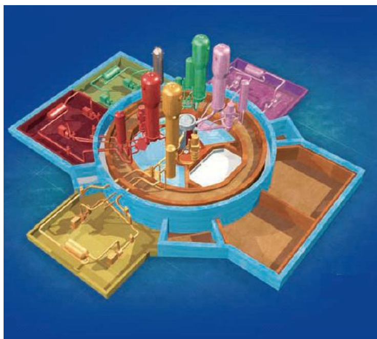
Bild Nr. 23 – Schematische Darstellung der Sicherheitssysteme des EPR1600
