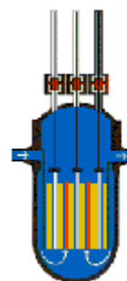
Bild Nr. 5 – Vereinfachte Darstellung des Prinzips der Regelung der Kernkettenreaktion
