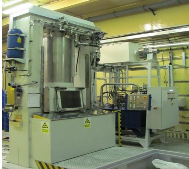
19.3.5-5. ábra: 50 kN-os automata hulladéktömörítő prés [19-5]
