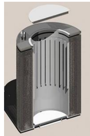
19.4.2-4. ábra: MAGNASTOR típusú tárolótartály és a befoglaló vasbeton konténer [19-34]
