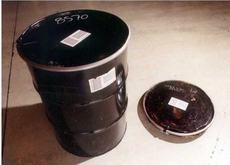
19.3.5-7. ábra: Kis aktivitású szilárd hulladék szuperkompaktálás előtt és után [19-7]
