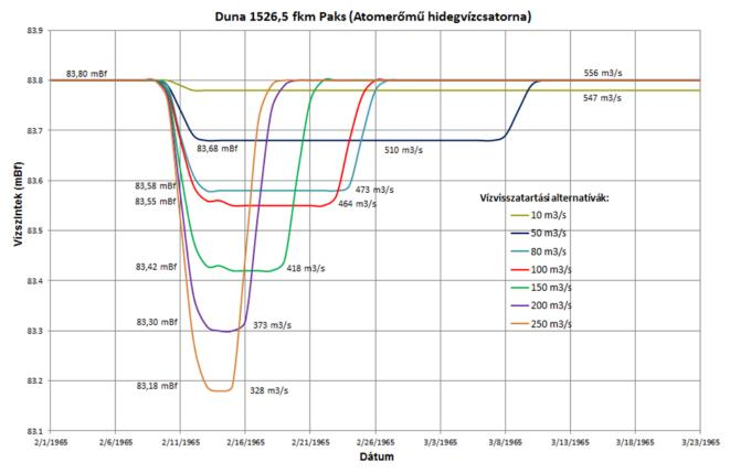
Legend: Dunacsúnyi duzzasztómű hatása a Paksi Atomerőműnél – The impact of the Cunovo barrage at the Paks Nuclear Power Plant
