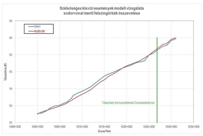
Szélsőséges kisvizi események modell vizsgálata sodorvonal menti felszngörbék összevetése - Model analysis of extreme low water flow events, comparison of the surface streamline along the mainstream Vízszint (mBf) – Water level (mBf) Duna Fkm - Danube river km
