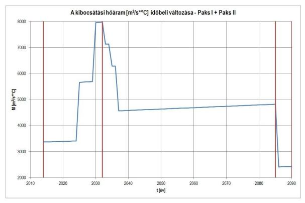
A kibocsájtási hőáram [m³/sec\*°C] időbeli változása - Paks II - Paks II - Changes in discharge heat flux as the Legend: function of time [m3/s\*oC1 - Paks I and Paks II
