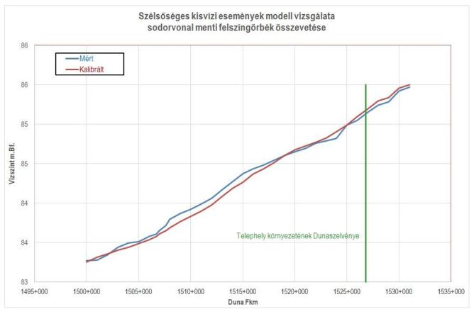
Legend: Szélsőséges kisvizi események modell vizsgálata sodorvonal menti felszíngörbék összevetése – Model analysis of extreme low water flow events, comparison of the surface streamline along the mainstream Vízszint (mBf) – Water level (mBf) Duna Fkm - Danube river km Mért – Measured Kalibrált – Calibrated Telephely környezetének Dunaszelvénye – Danube section in the vicinity of the Site
