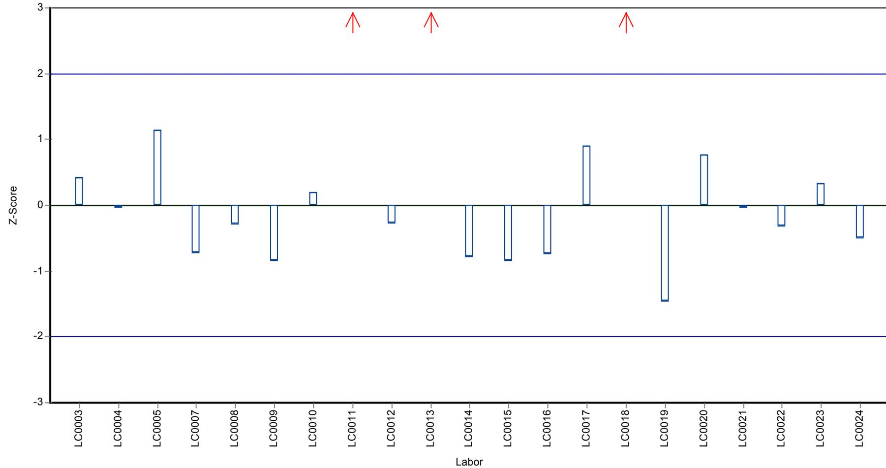
Parameterorientierte Auswertung Leichtflüchtige halogenierte Kohlenwasserstoffe (LHKW), BTEX und MTBE - CB01 Probe: CB01ACKW, Merkmal: Dibromchlormethan
