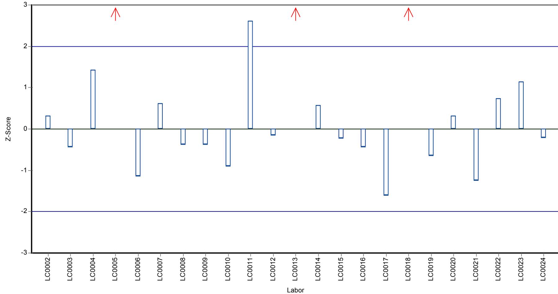
Parameterorientierte Auswertung Leichtflüchtige halogenierte Kohlenwasserstoffe (LHKW), BTEX und MTBE - CB01 Probe: CB01ACKW, Merkmal: cis-1,2-Dichlorethen
