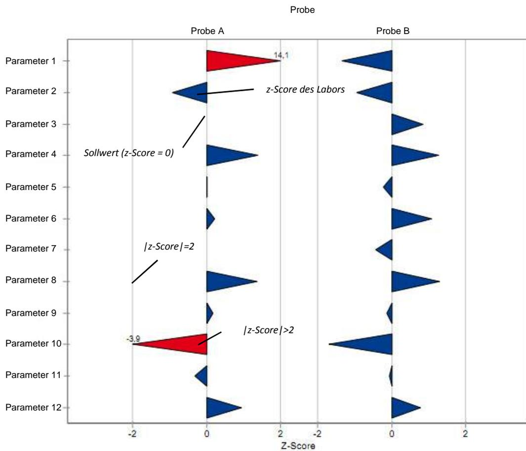
Zusammenfassung der Ringversuchsergebnisse, ausreißerbereinigt: Leichtflüchtige halogenierte Kohlenwasserstoffe (LHKW), BTEX und MTBE - CB01
