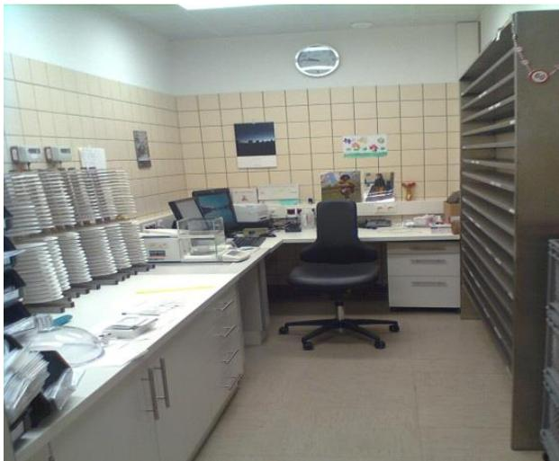
Der Raum befindet sich im EG und ist ca. 16,6 m<sup>2</sup> groß; keine Fenster, lediglich eine Tür mit Glasfüllung; Unterschränke; Wägetisch; Klimaschrank; Edelstahlwandregal; Filterstative; Waage; PC's
