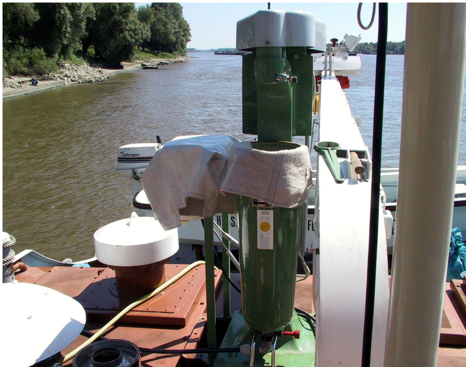
Abb. 4: Schwebstoff-Probenahme mit der Zentrifuge (Foto: JDS)
