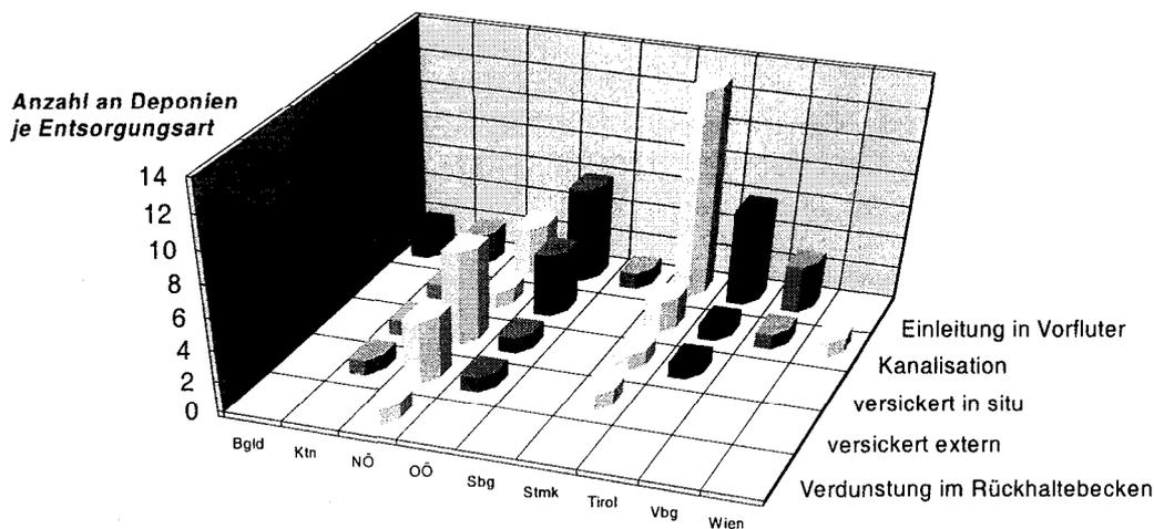
Abb.56: Art der Oberflächenwasserentsorgung bei Deponien nach Bundesländern.
