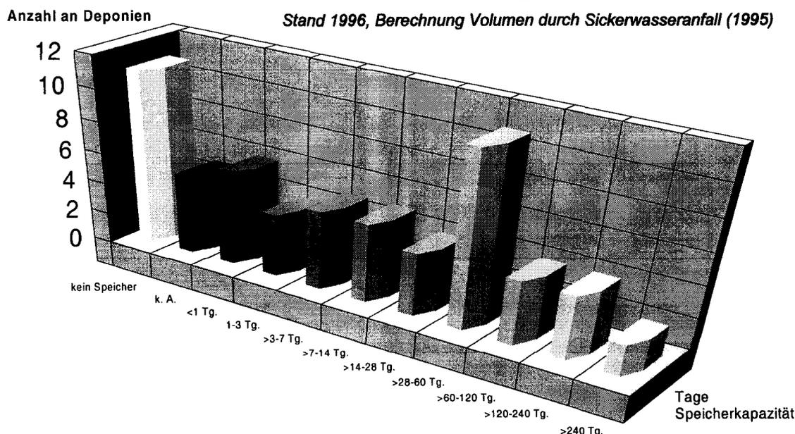
Abb.52: Speicherkapazität des Sickerwasserzweischenspeichers in Tagen durchschnittlichen Sickerwasseranfalls.
