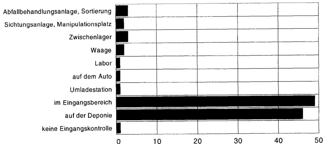
Abb. 31: Ort der Eingangskontrolle bei Mülldeponien.
