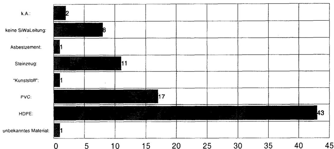
Abb. 45: Sickerwasserleitungen bei Mülldeponien sowie deren Material.
