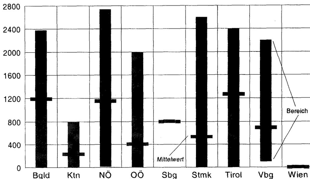
Abb.48: Volumina der Sickerwasserzweischenspeicher ( Bereiche und Mittelwerte).
