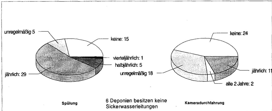
Abb. 46: Spülung und Kameradurchfahrung bei Sickerwasserleitungen.
