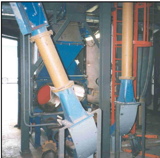
Abbildung 11: Förderleitungen nach der Wägungsvorrichtung
