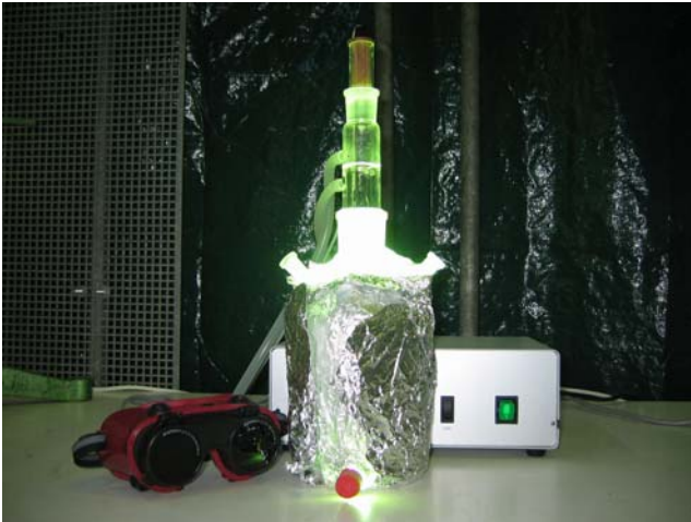
Abb. 9: Reaktor mit Mitteldruckstrahler TQ 150
