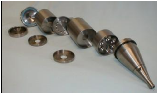
Abbildung 108: Kaskadenimpaktor Johnas 2 mit drei Filterstufen der Firma Paul Gothe Bochum.
