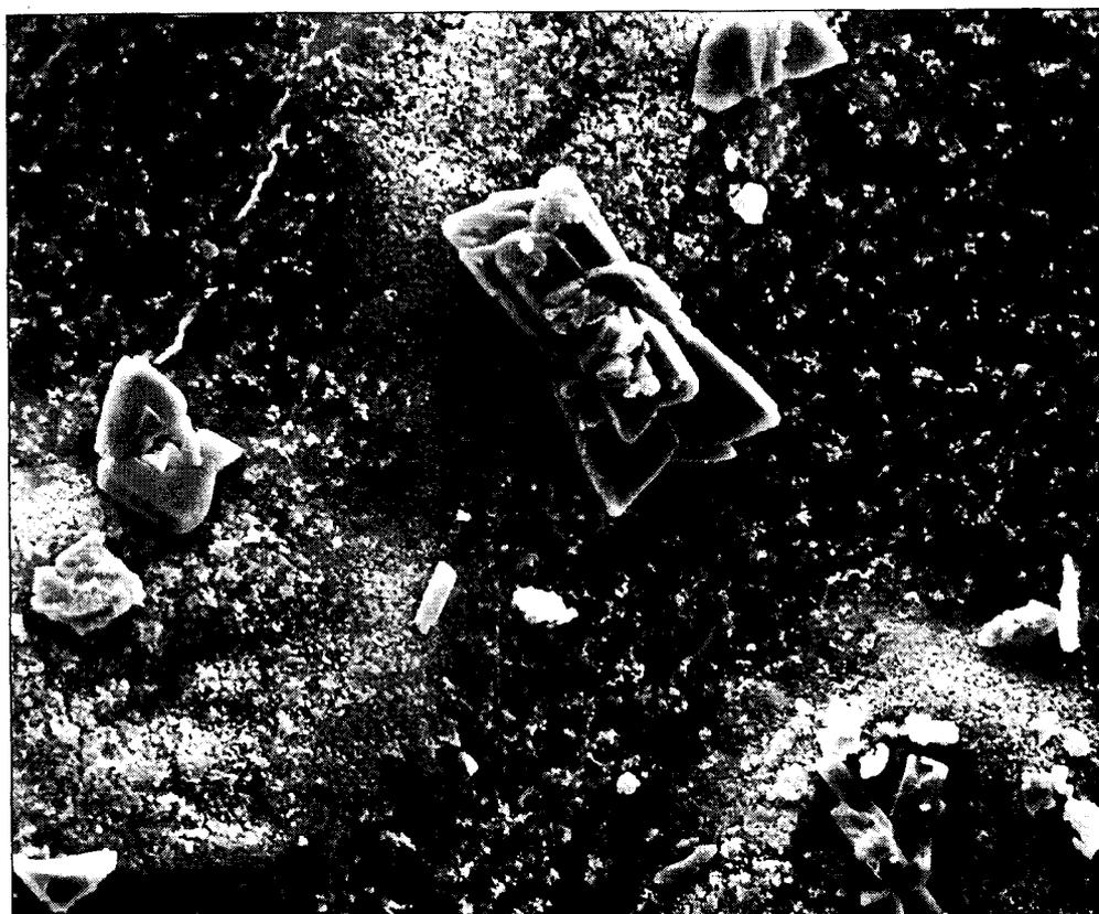
Abb. 30: Leoben-Donawitz/103, REM-Aufnahme einer Fichtennadel mit Gipskristallen. Vergrößerung: 750fach.
