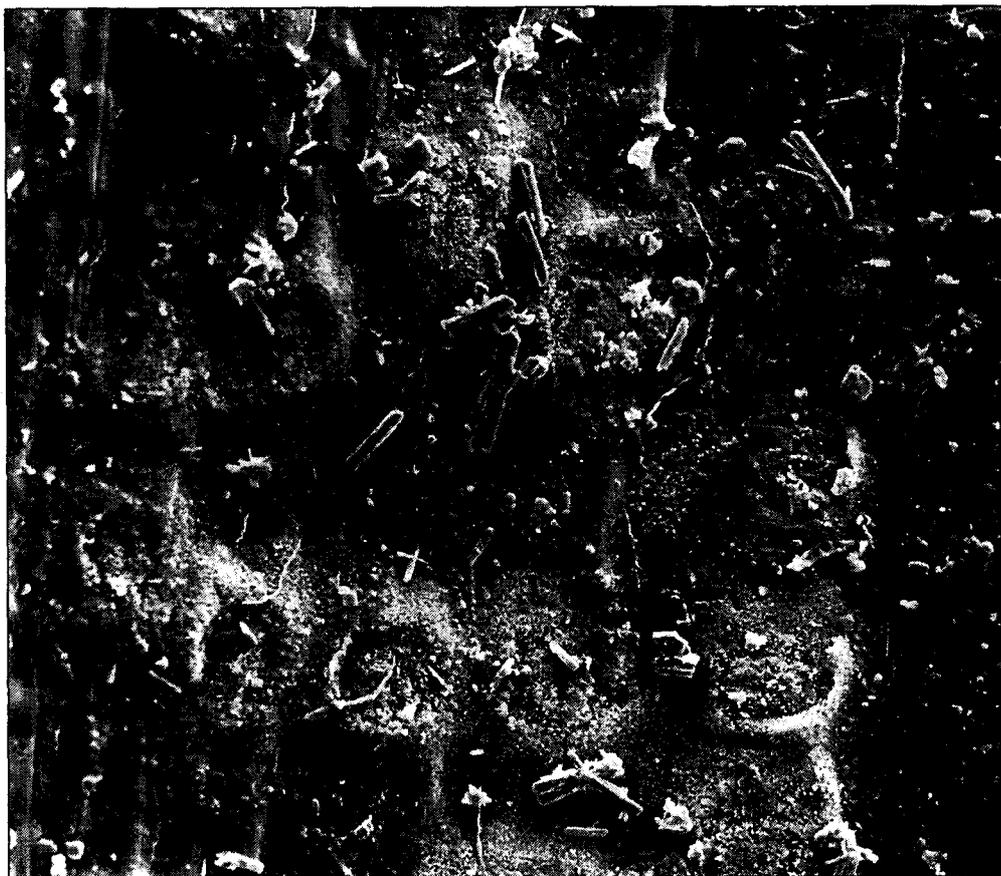
Abb. 13: Breitenau/116, REM-Aufnahme eines Nadelbereiches mit zahlreichen Gipskristallen. Vergrößerung: 350fach.
