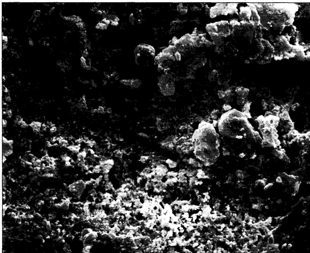
*Abb. 37: Linz/Kürnberger Wald, REM-Aufnahme einer Spaltöffnung mit starker Wachsdegradation und Staubbelegung. Vergrößerung: 3000fach.*
