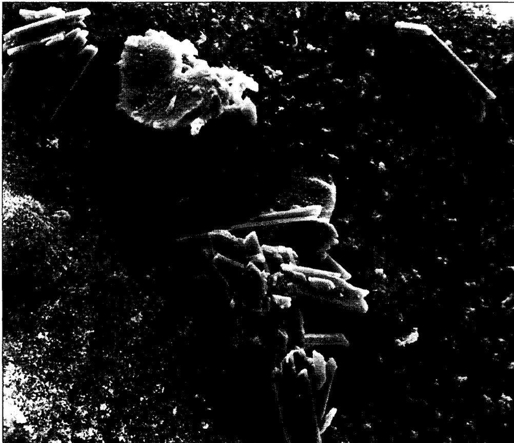
Abb. 48: Reutte/R29, REM-Aufnahme eines Nadelbereichs mit zahlreichen Gipskristallen. Vergrößerung: 1000fach.
