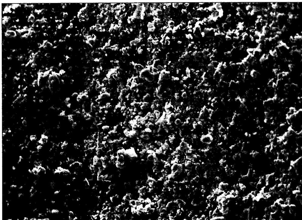
Abb. 44: A12, Profil Radfeld/U-1806/1, REM-Aufnahme eines Nadelbereichs mit massiver Staubbelagerung. Vergrößerung: 350fach.
