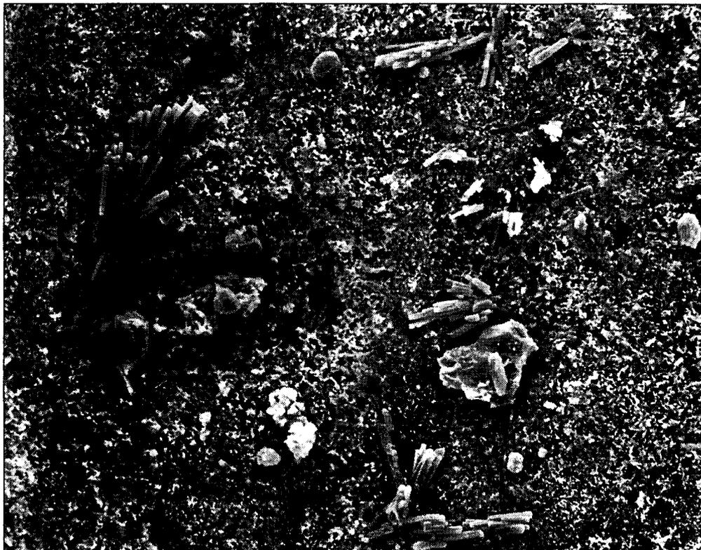
Abb. 35: Leoben-Donawitz/76, REM-Aufnahme eines Nadelbereiches mit zahlreichen anhaftenden Gipskristallen. Vergrößerung: 1150fach.
