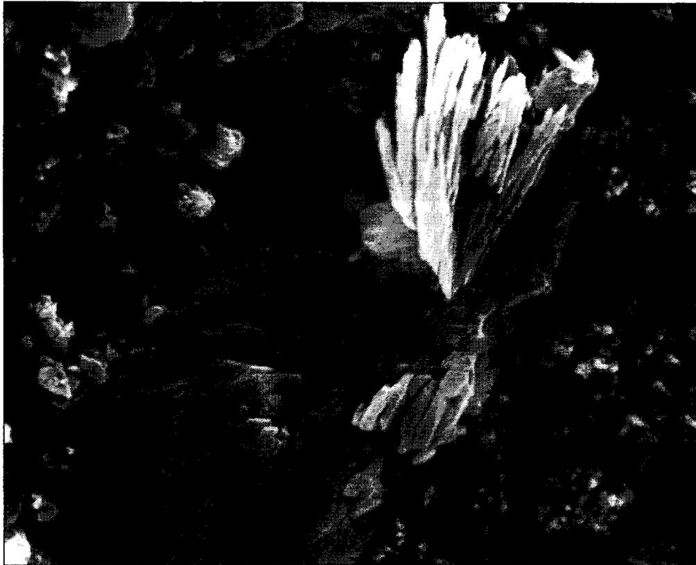
Abb. 19: Brückl/B 18/1, REM-Aufnahme eines Gipskristalles auf der Nadeloberfläche. Vergrößerung: 4600fach.
