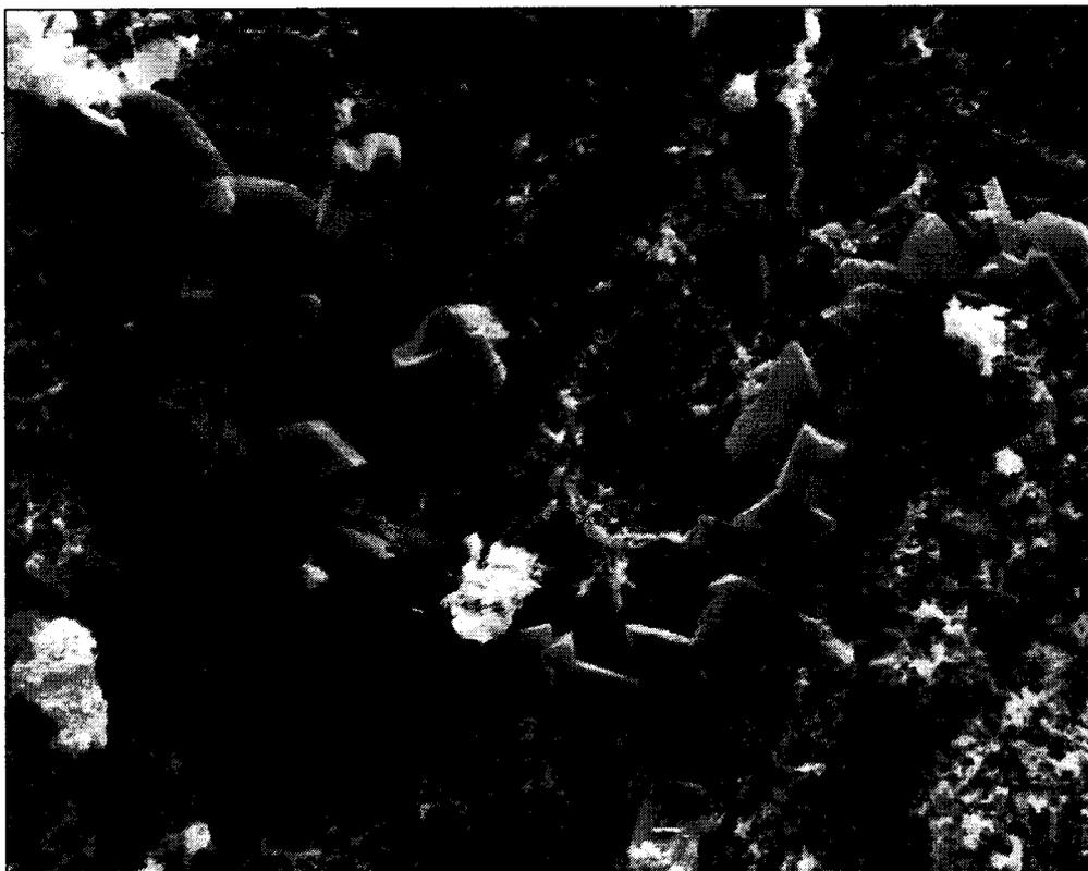
Abb. 58: *Wietersdorf/W 18/1, REM-Aufnahme von kleinen Gipskristallen. Vergrößerung: 2300fach.*
