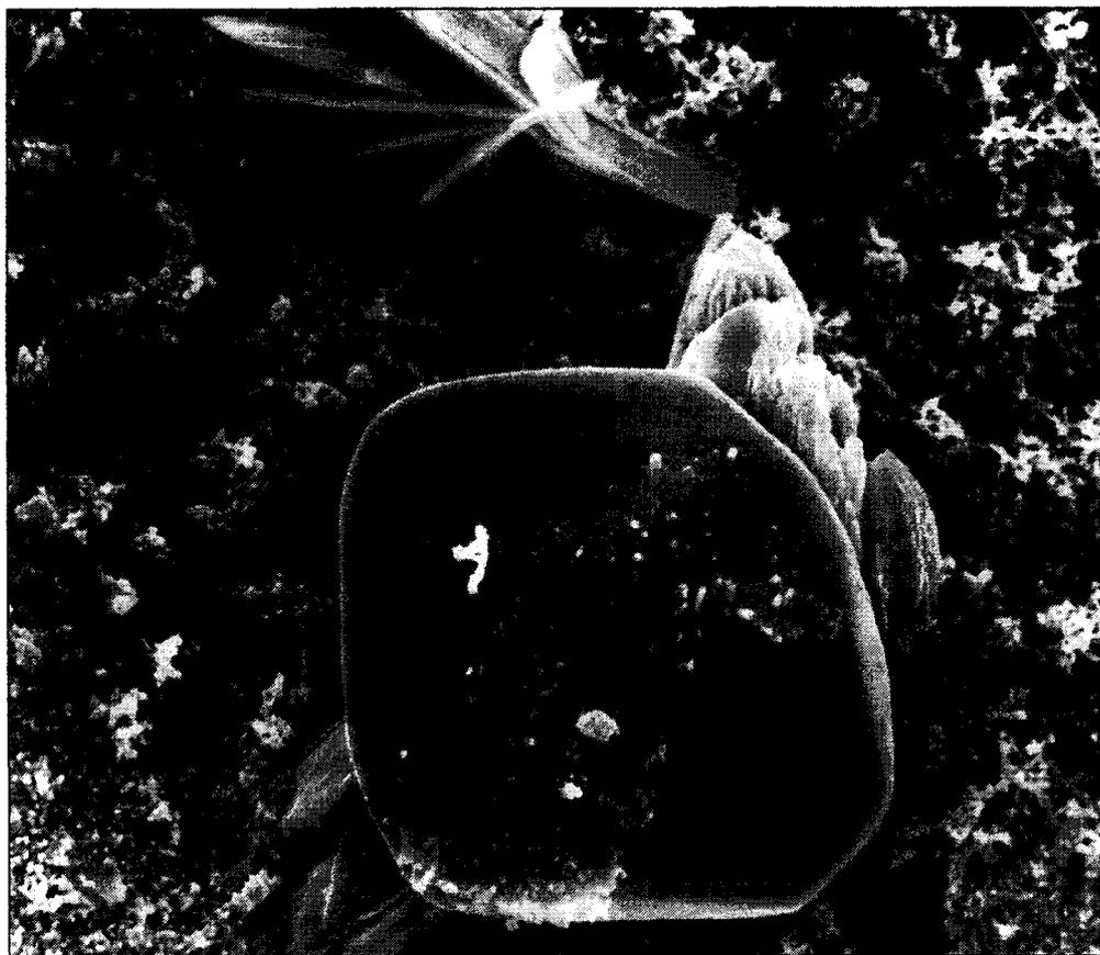
Abb. 23: Brückl/SW1/2, REM-Aufnahme eines NaCl-Kristalles aufgelagert auf Gipsnadeln. Vergrößerung: 3000fach.
