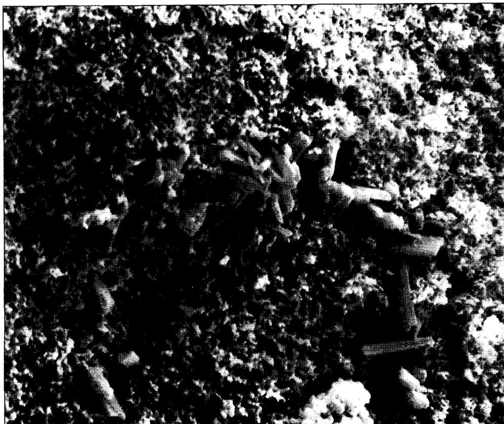
Abb. 46: A 12, Profil Radfeld/U-1807/1, REM-Aufnahme einer Spaltöffnung mit zahlreichen kleinen Gipskristallen. Vergrößerung: 3000fach.
