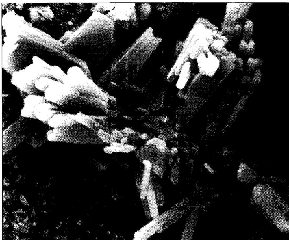
Abb. 36: Leoben-Donawitz/76, REM-Aufnahme eines Gipskristalles im Detail. Vergrößerung: 4500fach.
