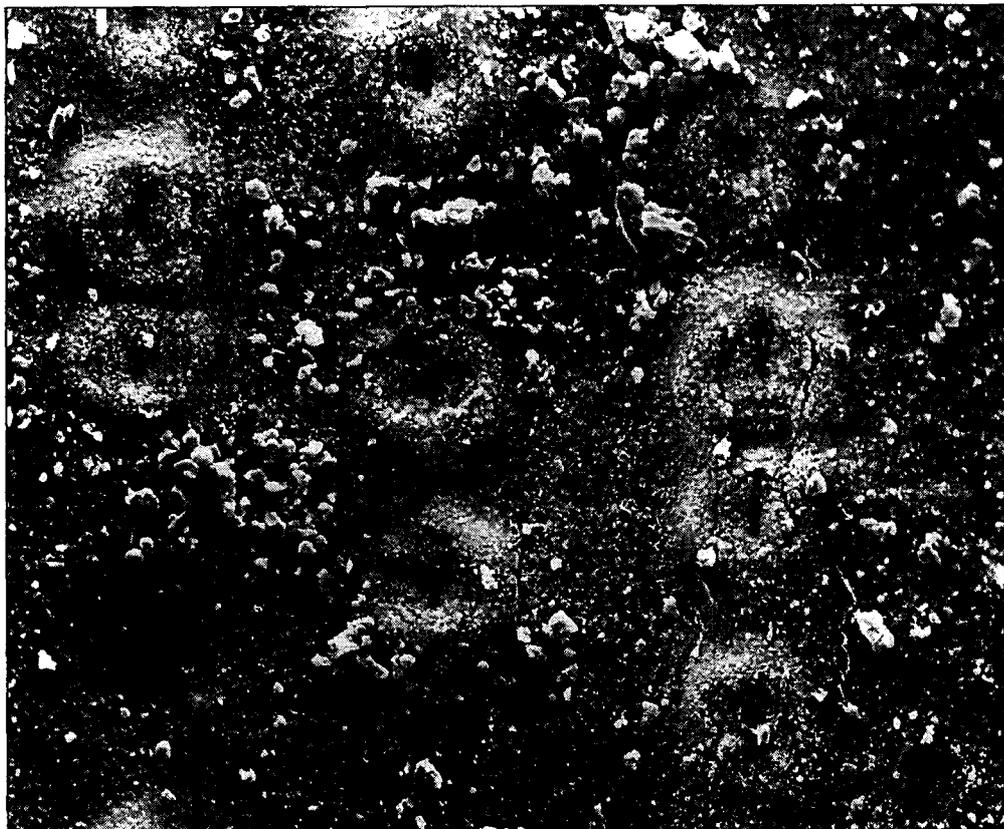
Abb. 28: Leoben-Donawitz/103, REM-Aufnahme einer Nadeloberfläche mit anhaftenden Staubpartikeln im Überblick. Vergrößerung: 350fach.
