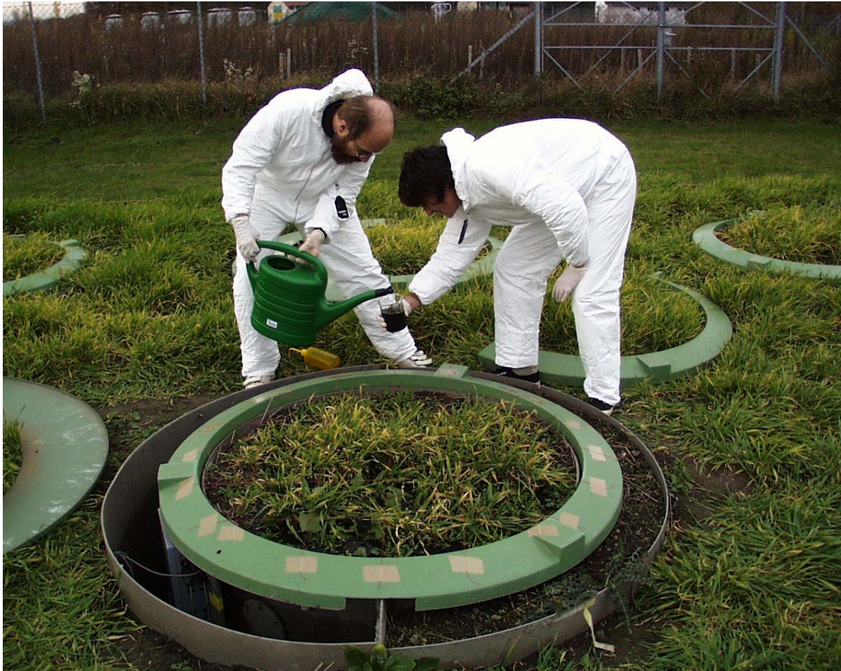
Abb. 6: Aufbringung des Klärschlammes auf das Lysimeter
