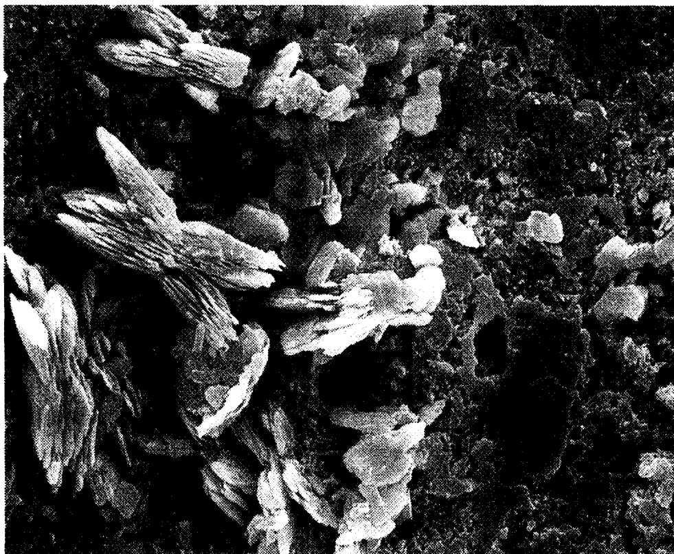
Abb. 40: PP. Wie 18/Wietersdorf, REM-Aufnahme einer Nadeloberfläche mit massiver Belegung durch Gipskristalle. Vergrößerung: 3000fach.
