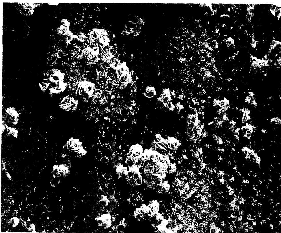
Abb. 23: PP. L 140/Stadtgebiet Linz, REM-Aufnahme eines Nadelbereichs mit zahlreichen Gipsrosen. Vergrößerung: 750fach.
