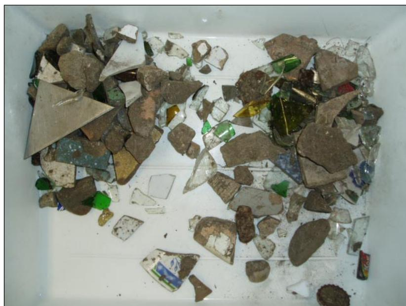
Abbildung 4: Fotodokumentation der MBA-Deponieoutputfraktion – Inertstoffe.
