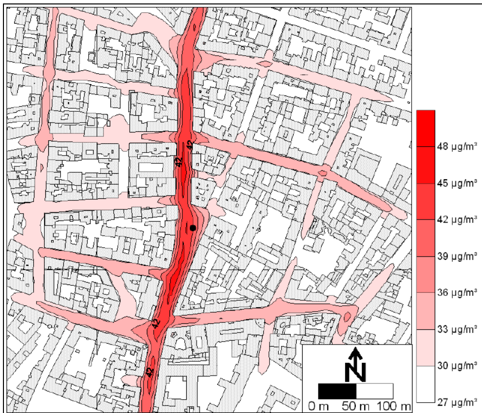
Abbildung 3: Modellierter Jahresmittelwert der \text{NO}_2 -Belastung im Jahr 2005 in der Umgebung der Messstelle Wien Taborstraße (Punkt). Die Größe des Modellgebietes beträgt etwa 500 \times 500 \text{ m}^2 (Quelle: pers. Mitteilung D. Öttl).
