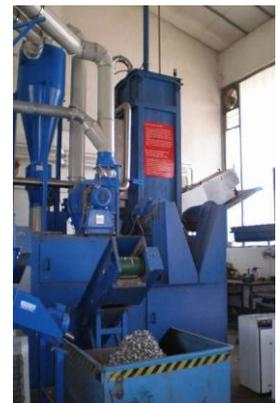
*Stufe II, Aufgabe der Geräte in Shredder*
