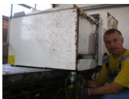
Stufe I, Absaugung des Kältemittels
