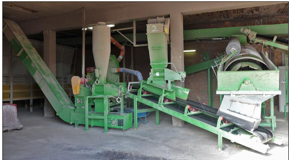
Abbildung 4: Drehsiebe und Häcksler zur Aufbereitung der Sägespäne (© Verband österreichischer Ziegelwerke).
