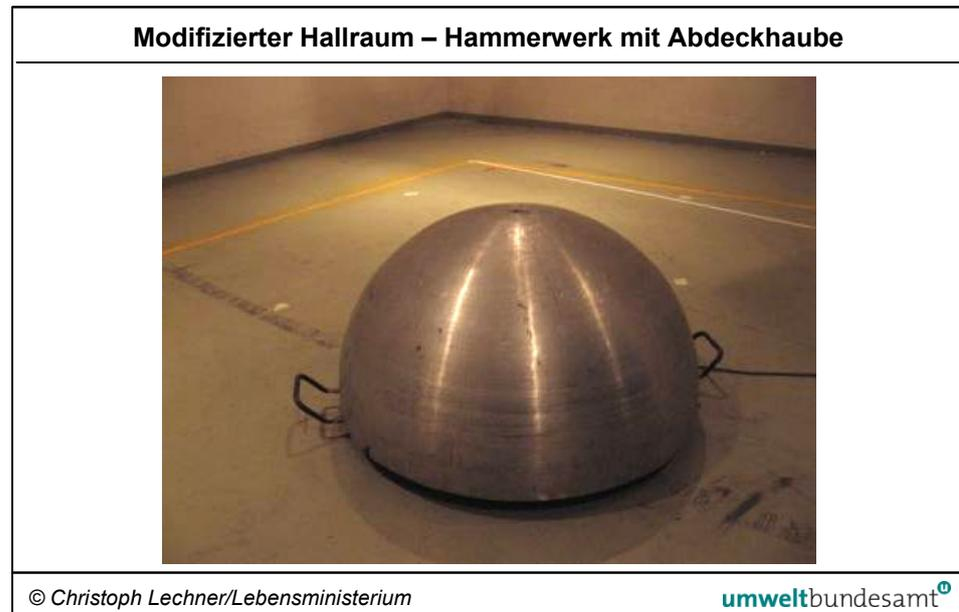
Abbildung 6: Hammerwerk mit Abdeckhaube im modifizierten Hallraum.
