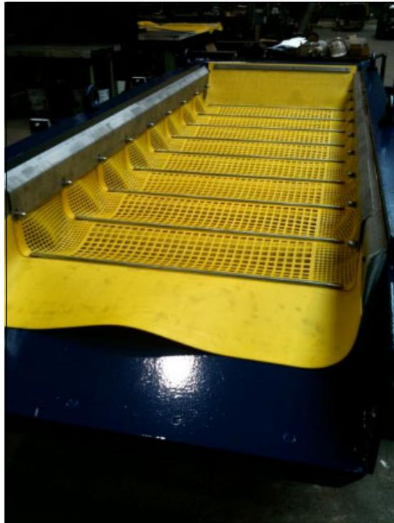
Abbildung 20: Siebmatten eines Spanwellensiebs.
