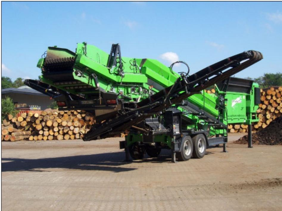
Abbildung 19: Mobiles Sternsieb. (© Neuenhauser Maschinenbau GmbH,
