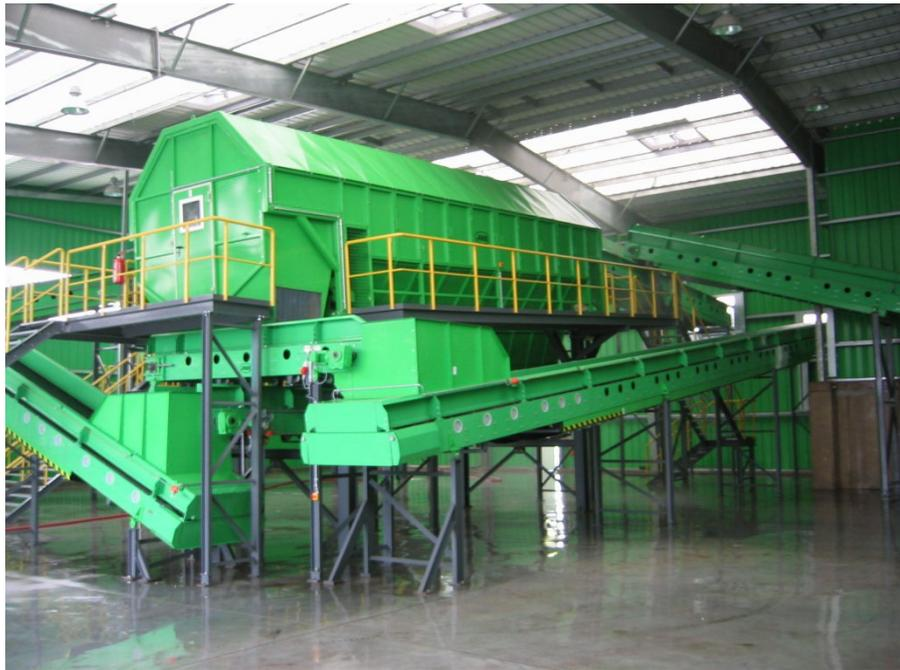
Abbildung 13: Stationäre Trommelsiebmaschine. (© AMB Anlagen Maschinen Bau GmbH)
