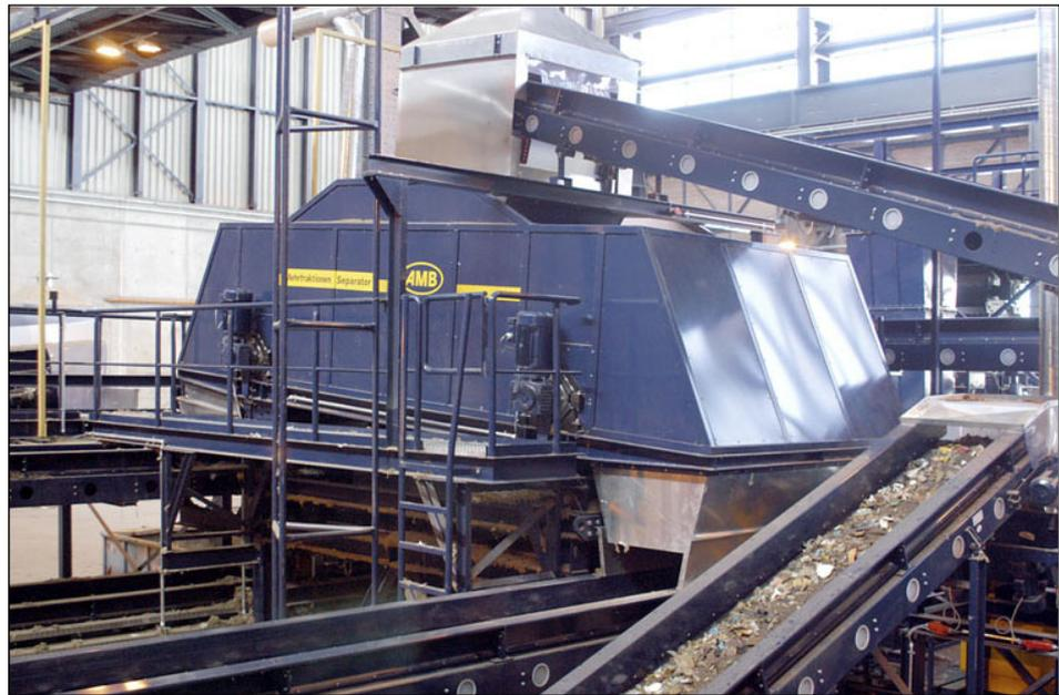
Abbildung 21: Mehrfraktionen-Separator für die Hausmüllaufbereitung. (© AMB Anlagen Maschinen Bau GmbH, Quelle: <http://www.amb-group.de/virthos/virthos.php?MASCHINENBAU/Trenn-+und+Mischtechnik>)
