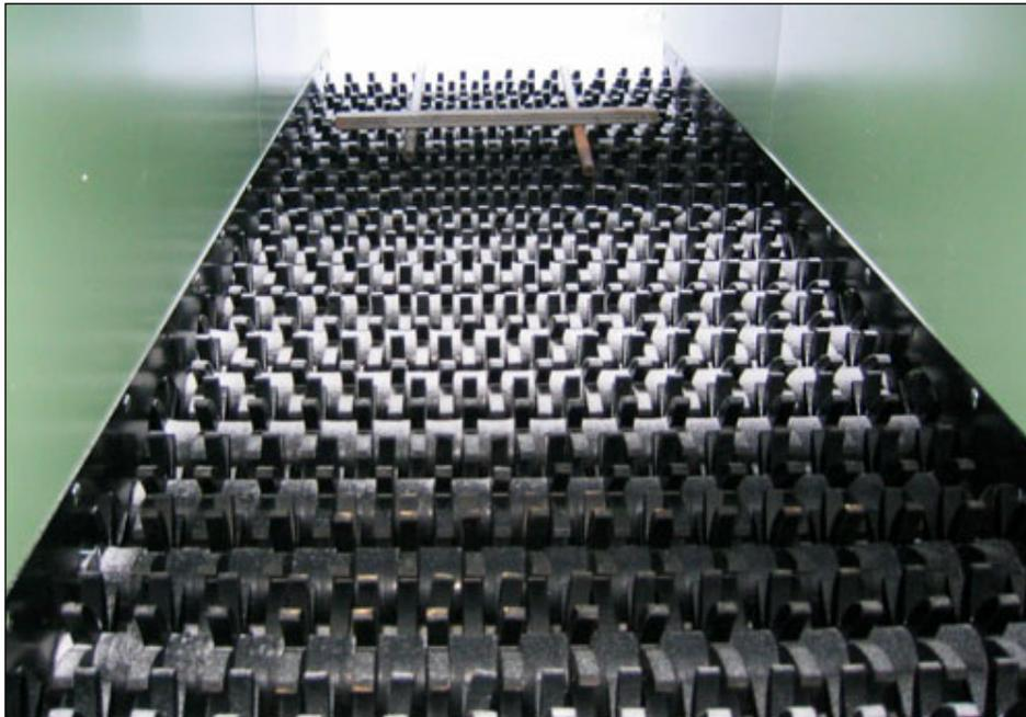
Abbildung 17: Sonderform eines Scheibensiebes – das Sternsieb.
