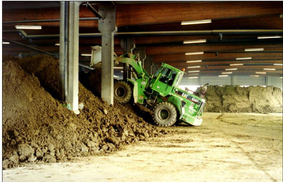
Sollte sich bei der laufenden Laborkontrolle herausstellen, dass eine Nährstoffzugabe notwendig ist, dann wird das Material ein weiteres Mal der Aufbereitungsanlage zugeführt.
