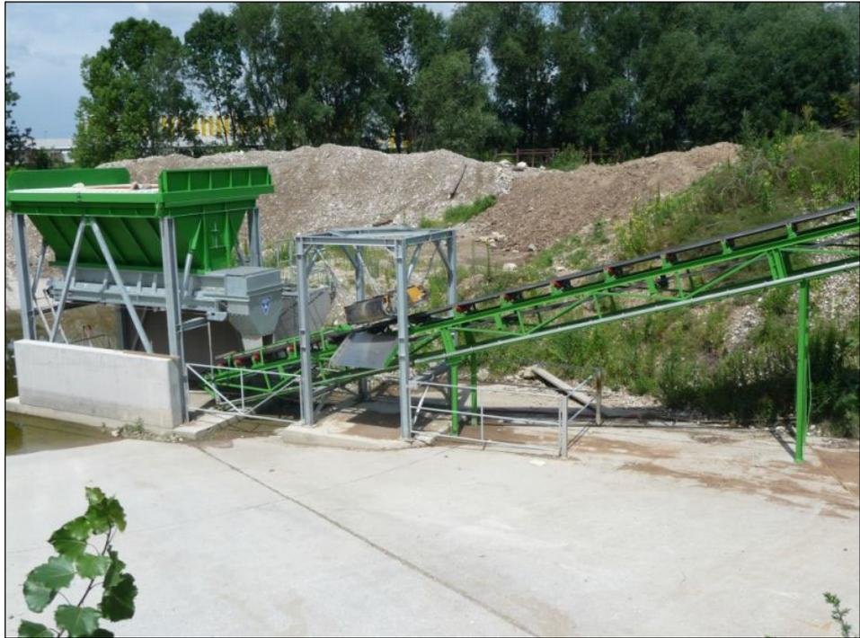
Das Material wird mittels Siebung (Kreisschwingsiebe) unter gleichzeitiger Bedüsung mit Wasser in drei Fraktionen klassiert: 0–4 mm, 4–32 mm und 32–150 mm.
