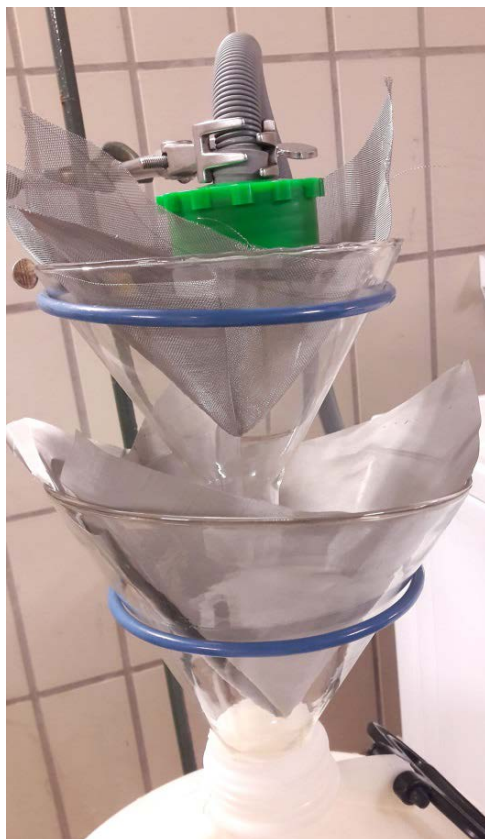
Abbildung 2: Einfache Filterkaskade, um Abwasser einer Haushaltswaschmaschine über 500 µm und 50 µm Edelstahlnetze zu filtern (© Umweltbundesamt/S. Köppel).
