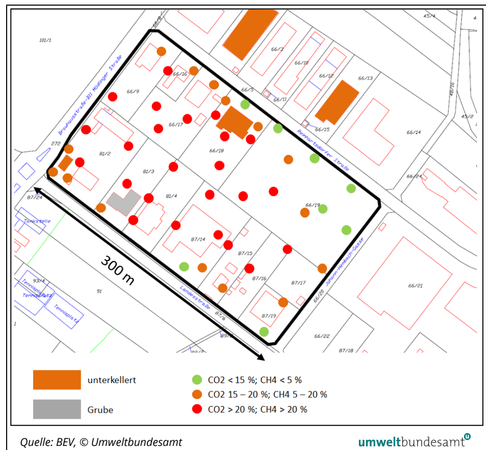
Abbildung 38: Umweltzustand vor den Maßnahmen am Standort „Deponie Rannersdorf“.
