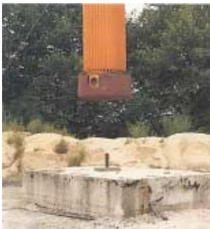
**Abbildung 9: Fall auf einen Stahldorn**
