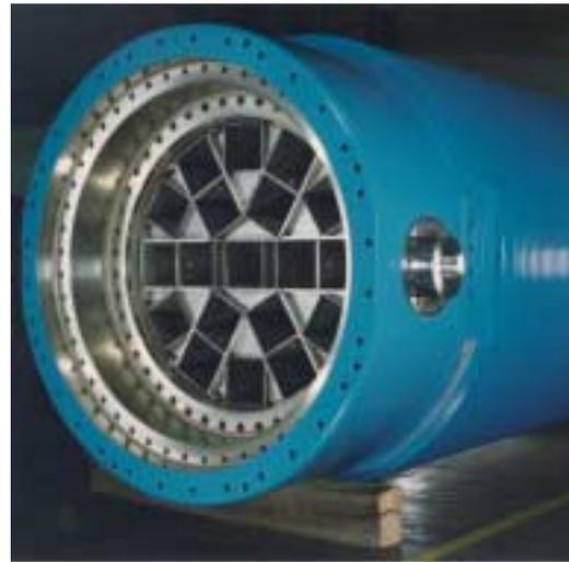
**Abbildung 7: Transport- und Lagerbehälter CASTOR V/19**
