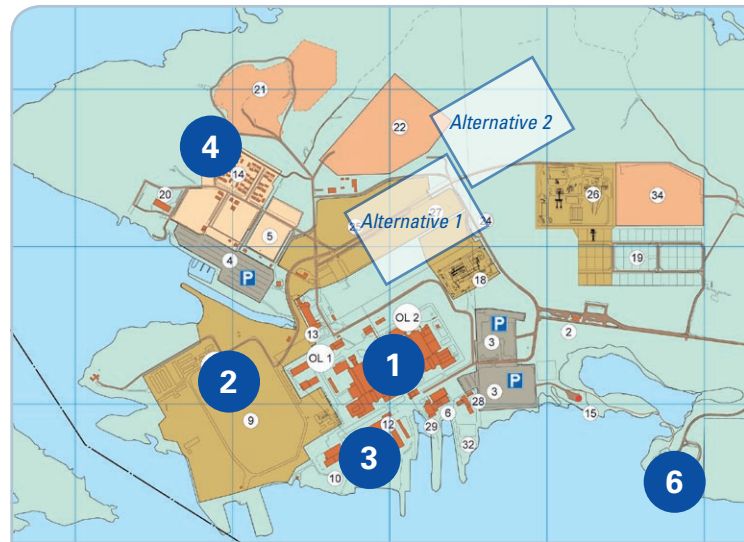
Bild 3. Kraftwerksgelände Olkiluoto. Auf der Karte sind u. a. die derzeitigen Kraftwerkblöcke OL1 und OL2 (1), die Baustelle des im Bau befindlichen Blocks OL3, das Lager für abgebrannten Brennstoff (3), das Endlager für Betriebsabfälle (4), die Endlagerung des abgebrannten Kernbrennstoffs, die Baustelle für den unterirdischen Forschungsraum (5) und das Besucherzentrum (6) zu sehen. Auf der Karte sind zudem die alternativen Standorte (Alternative 1 und 2) des neuen Kraftwerks eingezeichnet.
