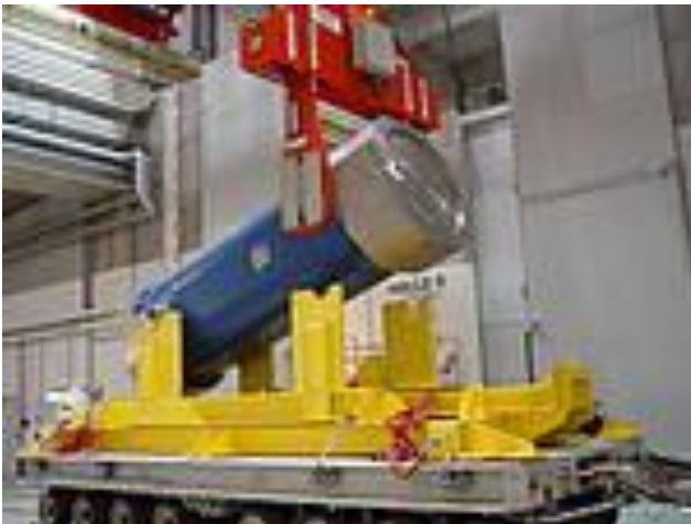
ZLN Transportbehälter CASTOR®KRB-MOX wird aus dem Transportgestell gehoben
