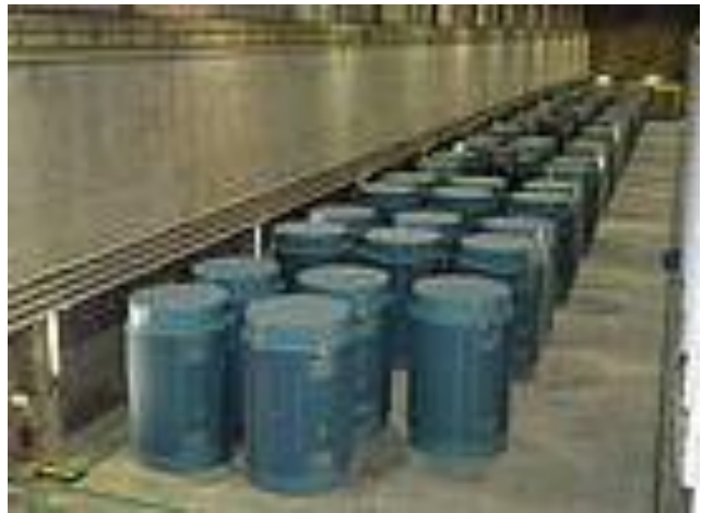
Halle 8 des Transportbehälterlagers im ZLN mit 65 CASTORen
