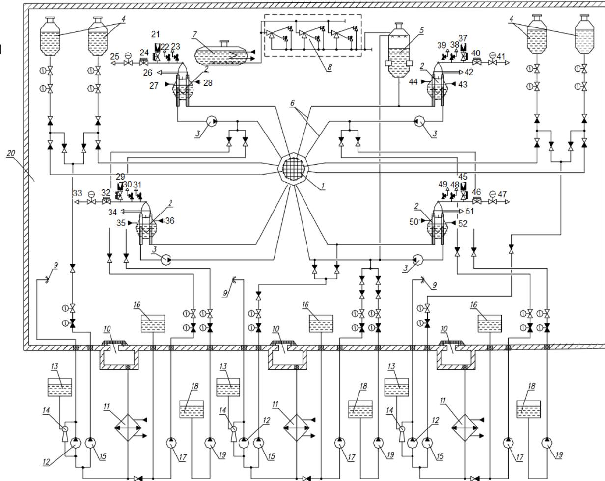
Abbildung 2.13 – Grundschemata des Reaktorbereiches für die Kraftwerksböcke Nr. 3 und 4 des Kernkraftwerks Khmelnitsky
