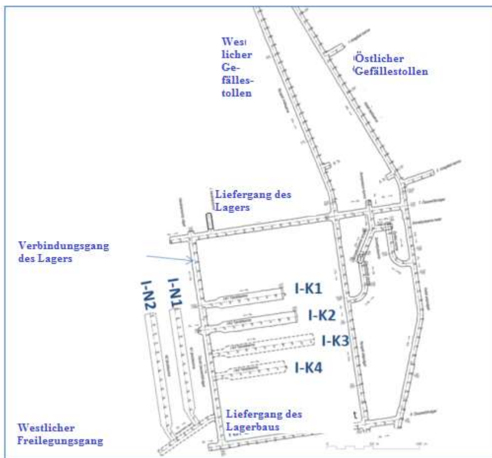
Abbildung 16: Das Streckensystem des Kammerfeldes I. des NRHT
