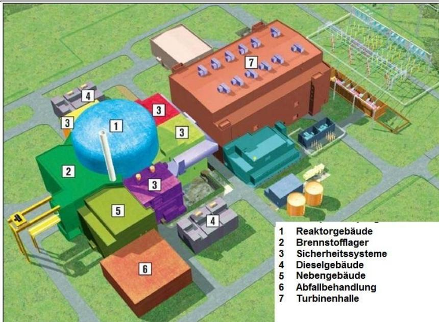
Abbildung 2.2.2.5-1. : Die wichtigsten Gebäude eines EPR - Blockes [5]
