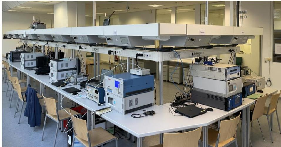
Während der Eignungsprüfung waren die Messgasleitungen der Messgeräte an die Ringleitung angeschlossen, welche jeweils 1,5 bzw. 2 Stunden mit unterschiedlichen Stoffmengenanteilen von NO und NO<sub>2</sub> und O<sub>3</sub> beschickt wurde. Den detaillierten zeitlichen Ablauf der Eignungsprüfung gibt Tabelle 3 und Tabelle 4 wieder.
