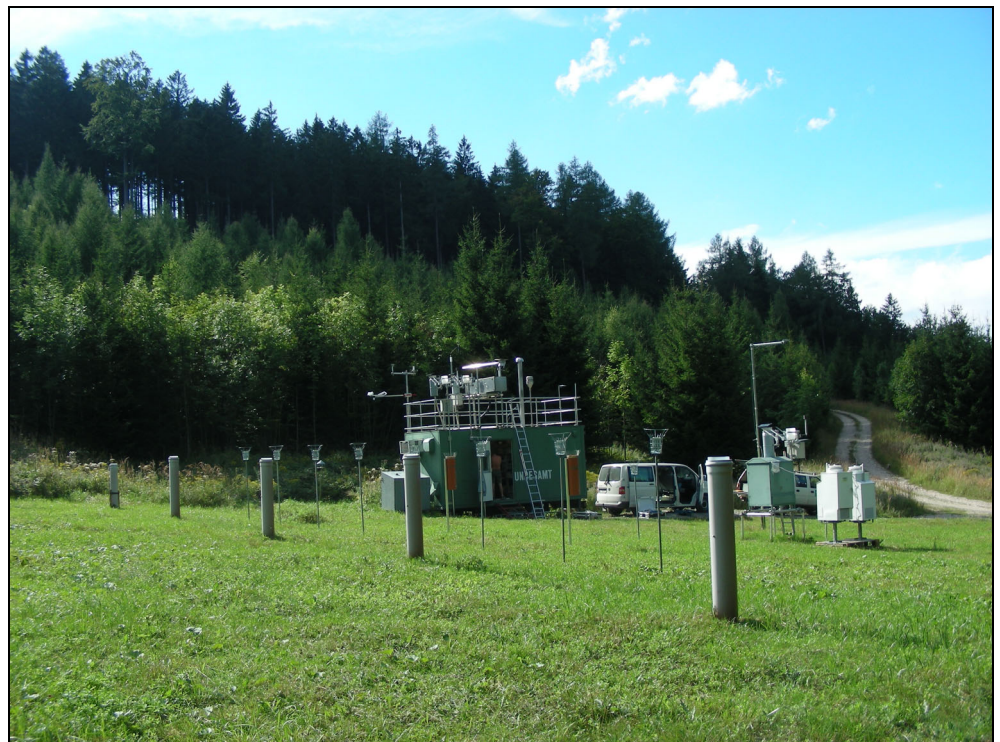
Abbildung 9: Messstelle Zöbelboden (Wildwiese) von Osten. Im Vordergrund stehen Niederschlags- und Stauniederschlagssammler, rechts WADOS. (© Umweltbundesamt, Rokop)
