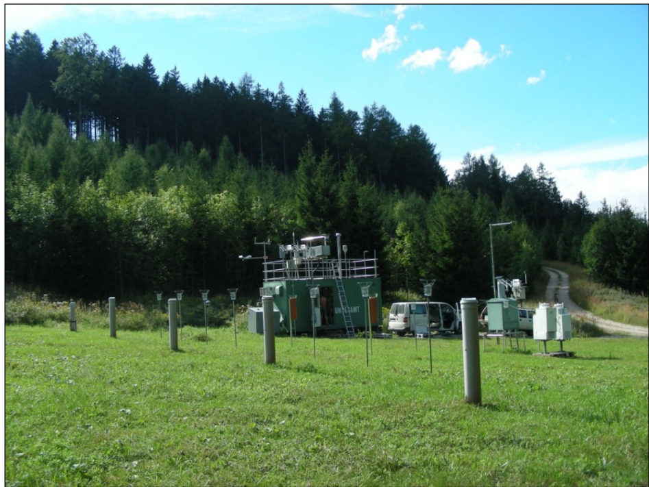
Abbildung 9: Messstelle Zöbelboden (Wildwiese) von Osten. Im Vordergrund stehen Niederschlags- und Stauniederschlagssammler, rechts WADOS für die nasse Deposition. (© Rokop/Umweltbundesamt)
