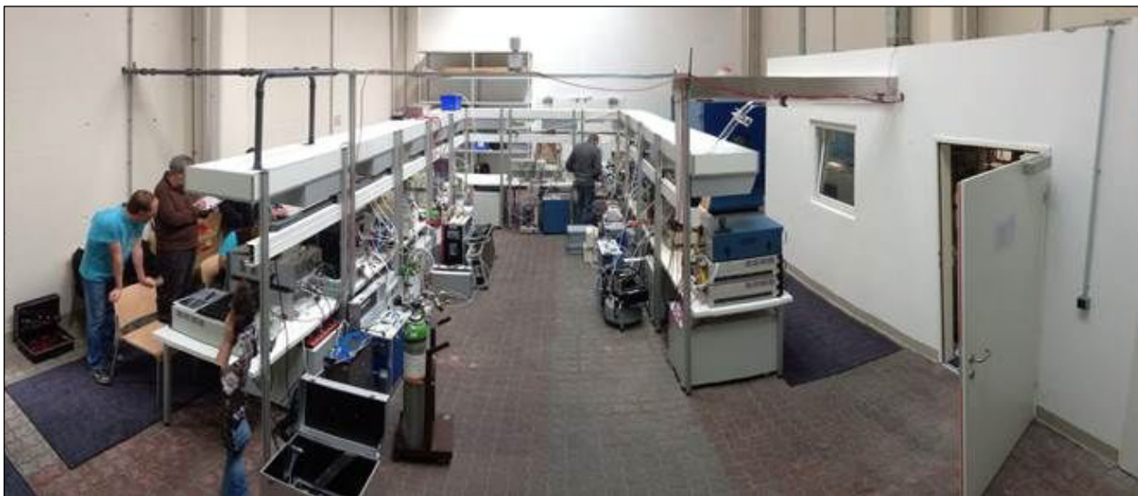
Abbildung 4: Die Anordnung der Arbeitsplätze gewährleistet freie Zugangsmöglichkeit zu allen Anschlüssen an den Geräterückseiten. (© Umweltbundesamt)
