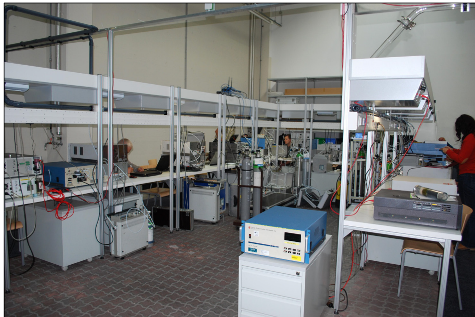
Abbildung 4: Die Anordnung der Arbeitsplätze gewährleistet freie Zugangsmöglichkeit zu allen Anschlüssen an den Geräterückseiten. (© Umweltbundesamt)
